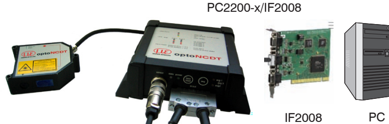
Abb. 23 Systemaufbau zum Betrieb der Interfacekarte IF2008
